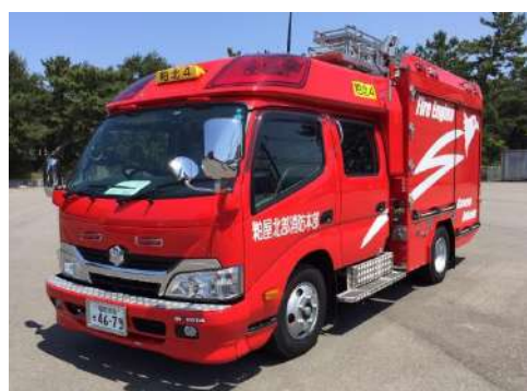
水槽付ポンプ車
